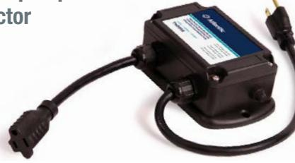
Le protecteur de pompe s'installe et se calibre facilement sur toutes les pompes à entraînement direct de 120 V jusqu'à 14 ampères. Il les protège contre la surchauffe, souvent causée par des surtensions ou des baisses de tension, se produisant lorsqu'elle n'est pas complètement submergée ou qu'elle est bloquée lorsque le courant excède l'un des deux niveaux prédéfinis. L'alimentation électrique de la pompe est interrompue jusqu'à ce qu'elle soit redémarrée manuellement.
